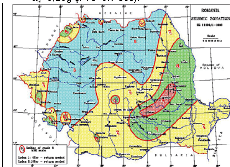
Zonarea seismică - Zona seismică de calcul are gradul seismic 6 ( cf. SR 11100/93) ( pentru care a_g = 0,10g și T_c = 0,7 sec).
